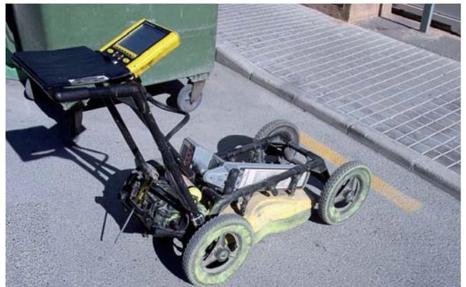
Figura 9.B. Antena georadar (GPR) de 250 MHz, que intentará realizar un radargrama con la silueta del cepellón de la palmera.
