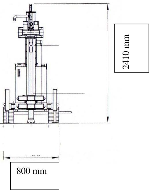
\* Altura de la máquina en transporte una vez abatido dispositivo de golpeo, lo que conlleva un aumento en la anchura de la máquina de 1400 mm
