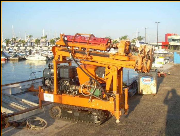
Máquina preparada para embarcarse para realizar traslado a la Isla de Tabarca donde se pretendía realizar estudio geotécnico
