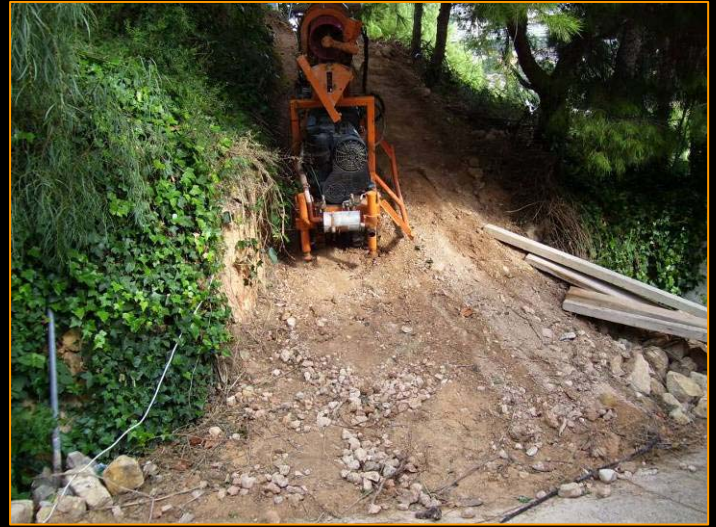
Máquina accediendo a un emplazamiento de sondeo por una rampa de 42°
