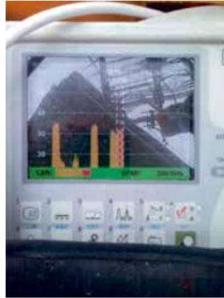
Aquí se ve la afectación después de la instalación del filtro de cavidades.
