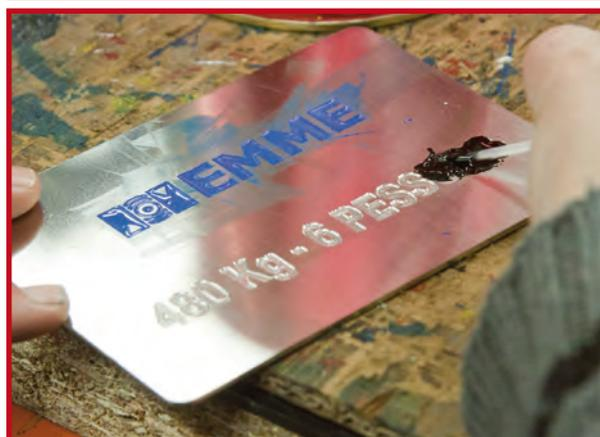
Grabados realizados con máquinas de última generación GRAVOGRAPH XP6000 que llegan hasta 20.000 rpm., especialmente diseñadas para trabajar el acero asegurando unos acabados perfectos.
