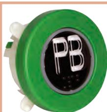
Pulsador de planta de salida del edificio. Se identifica con un anillo verde que debe sobresalir 0.5 mm por encima de los demás pulsadores existentes en la botonera, cumpliendo EN 81-70.
