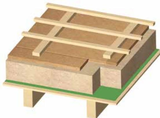
Solución constructiva de aislamiento sobre cabios con GUTEX Thermosafe-homogen y GUTEX Multiplex-top
