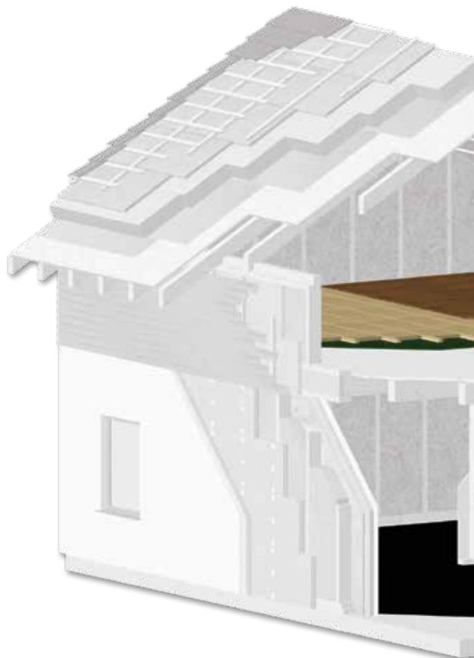
*GUTEX Happy Step se coloca de forma flotante y a mata juntas. Como terminación del suelo se emplea un laminado, parqué flotante o moqueta.*
