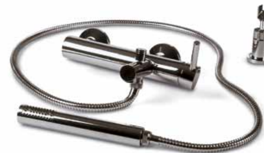
MONOMANDO "CILINDRO" PARA BAÑO Y DUCHA Con cartucho cerámico y juego de conexiones. Completo, con ducha, tubo flexible y soporte. Admite tubos desde 15 hasta 17 cm. de separación. En latón cromado.
