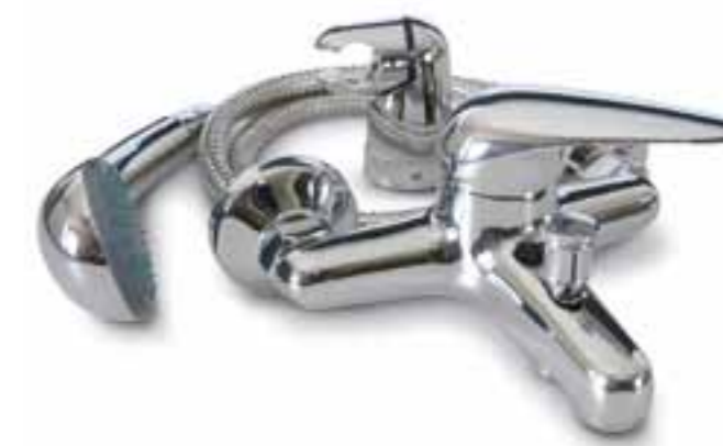
MONOMANDO "ESPACIO" PARA BAÑO Y DUCHA Con cartucho cerámico. Completo, con ducha, tubo flexible y soporte. Admite tubos desde 12,5 hasta 17,5 cm. de separación. En latón cromado.
