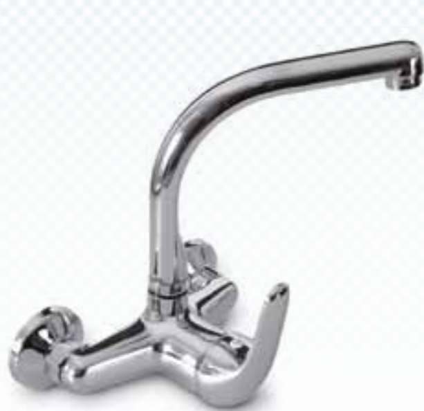
MONOMANDO MURAL "ESPACIO" PARA FREGADERO Con caño giratorio y cartucho cerámico. Admite tubos desde 12,5 hasta 17,5 cm. de separación. En latón cromado.
