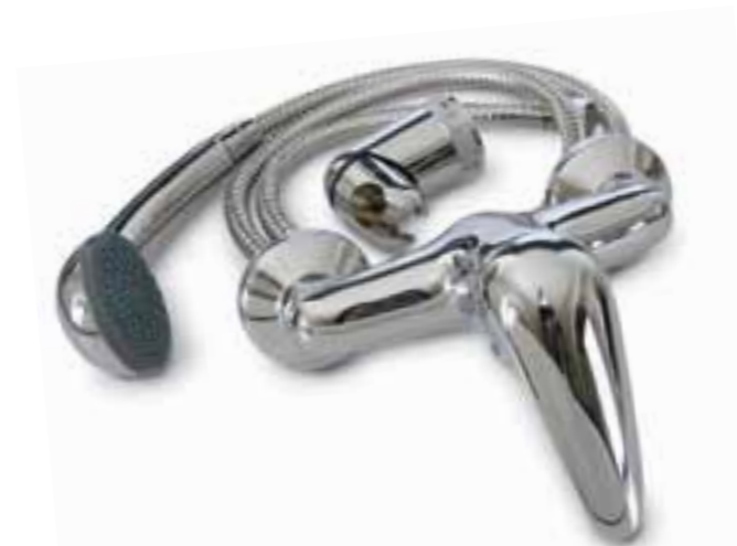
MONOMANDO "ESPACIO" PARA DUCHA Con cartucho cerámico. Completo, con ducha, tubo flexible y soporte. Admite tubos desde 12,5 hasta 17,5 cm. de separación. En latón cromado.
