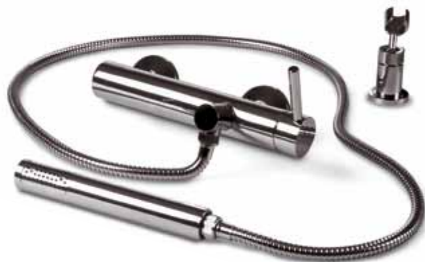
MONOMANDO "CILINDRO" PARA DUCHA Con cartucho cerámico y juego de conexiones. Completo, con ducha, tubo flexible y soporte. Admite tubos desde 15 hasta 17 cm. de separación. En latón cromado.
