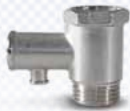
VALVULA DE SEGURIDAD PARA TERMOS En latón niquelado. Presión de tarado 8 bar.
