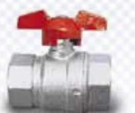
VALVULA ESFERA DE PASO TOTAL Hembra-Hembra. En latón y juntas teflón.
