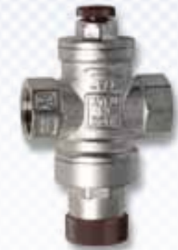
VALVULA REDUCTORA DE PRESION PARA TERMOS Presión máxima entrada: 10 bar. Campo de regulación: 1-4 bar. En latón.
