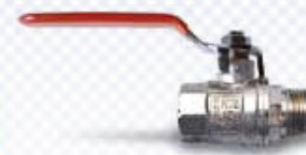
VALVULA ESFERA DE PASO TOTAL Macho-Hembra. En latón y juntas teflón.
