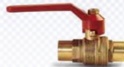
VALVULA ESFERA DE PASO TOTAL Para soldar. En latón y juntas teflón.
