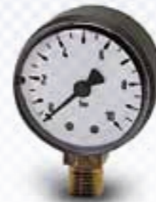
MANOMETRO UNIVERSAL RADIAL De 50mm. Ø. De 0 a 10 bar.
