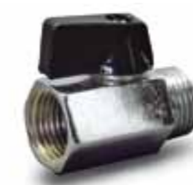
VALVULA MACHO-HEMBRA TIPO MINI Cierre de esfera. En latón cromado.
