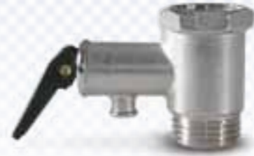
VALVULA DE SEGURIDAD PARA TERMOS CON PURGADOR En latón niquelado. Presión de tarado 8 bar.
