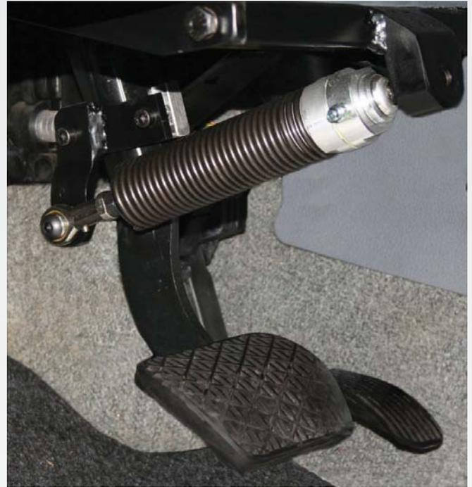
La ayuda hidráulica para el pedal puede usarse para ayudar al embrague original o al pedal de freno original. Reduce la fuerza necesaria sobre el pedal a tan solo 15 Nm o 1,5 KG.
