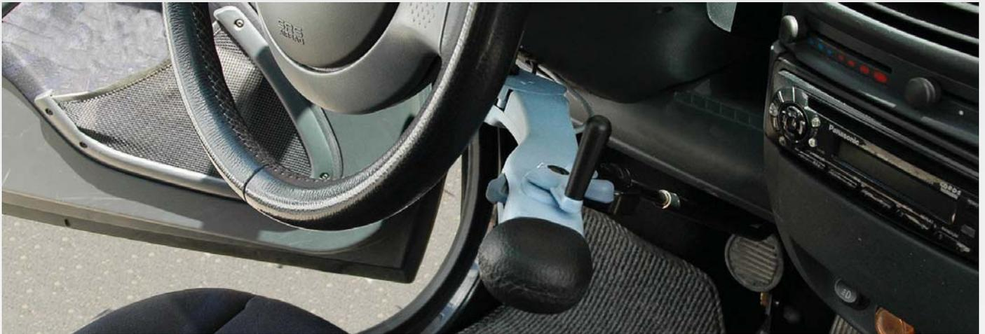
El mecanismo de desconexión de seguridad elimina la aceleración en el vehículo al instante y se vuelve a activar al dejar de frenar. En el caso de utilizar el acelerador y del freno simultáneamente, el acelerador se anula.
