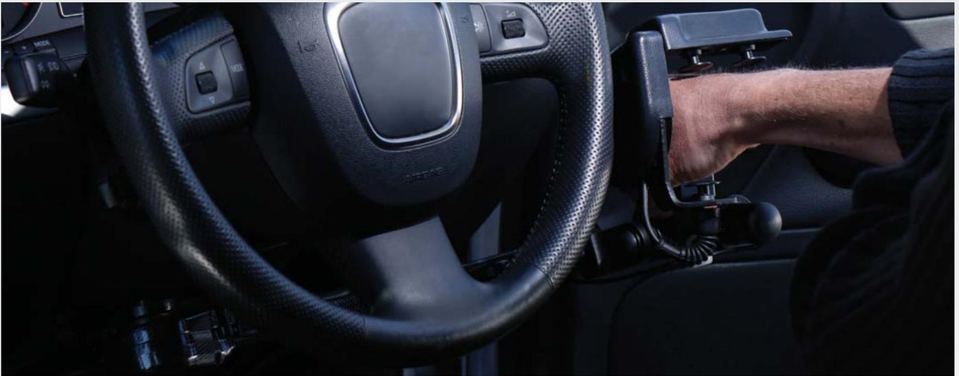
El frenado se consigue empujando en dirección del pedal original, al llevar el brazo largo proporciona una mayor influencia sobre el pedal y esto hace que realices menos esfuerzo, se requiere aproximadamente un tercio menos de esfuerzo en comparación con una palanca de freno estándar. El acelerador se activa inclinando la palanca hacia abajo (giro radial).
