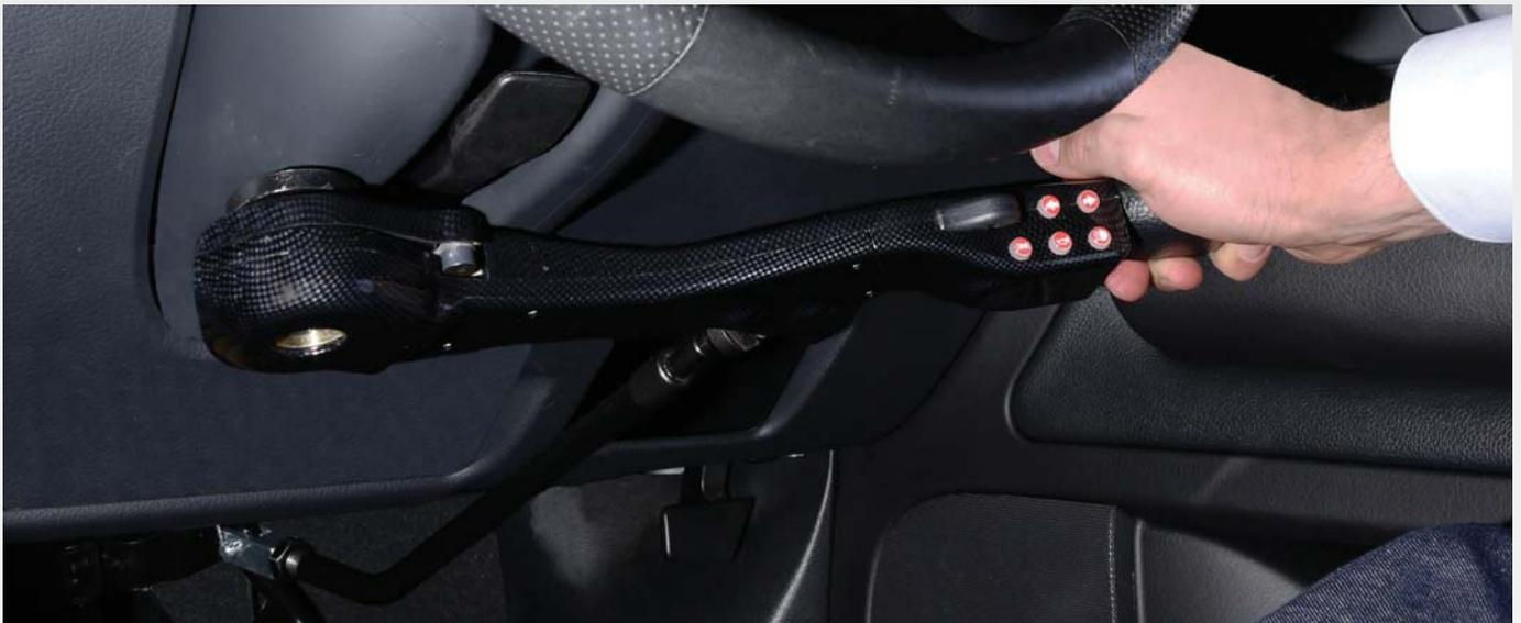
El frenado se logra empujando la palanca en dirección al pedal original de freno. La ausencia de vínculos secundarios para la función del acelerador asegura una acción libre que ofrece el medio más seguro y más eficiente de accionar mecánicamente el freno.
