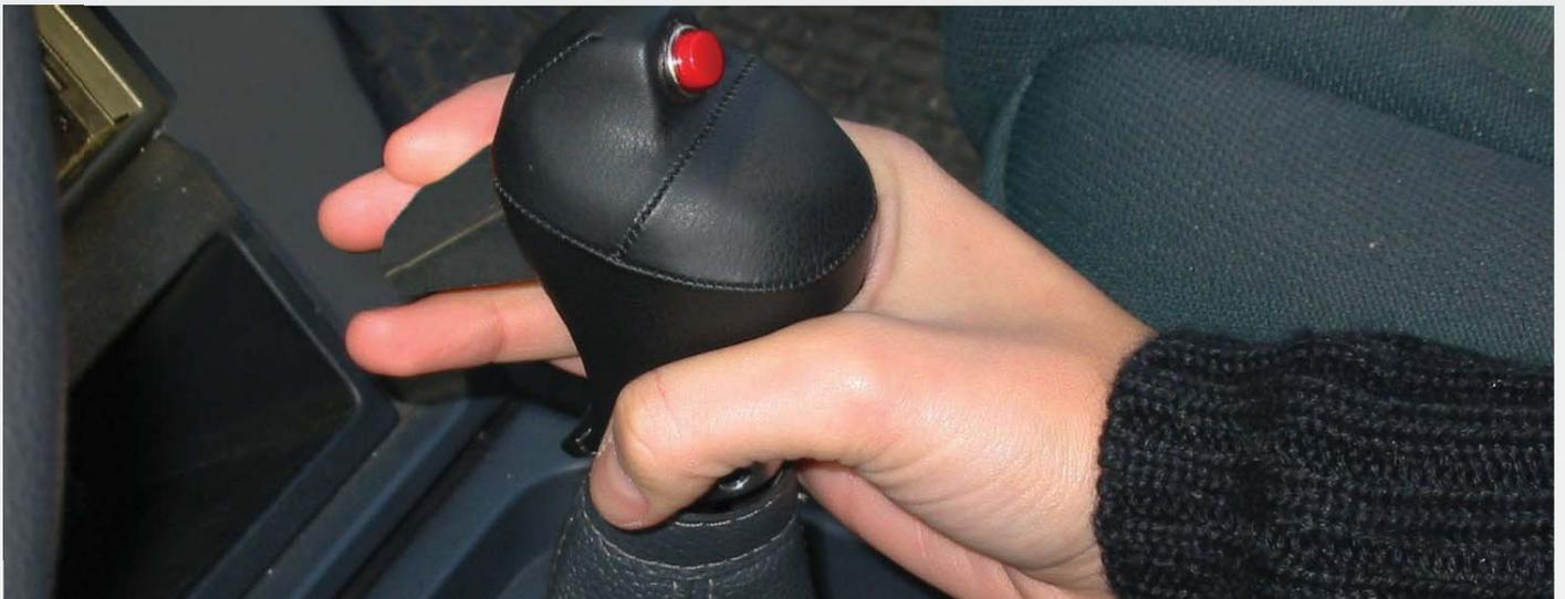
El pomo del cambio original se reemplaza por una de las tres opciones disponibles: el pomo con palanca, el pomo táctil o el sistema de sensor infrarrojo. El sistema funciona con una interfaz electrónica que gestiona la posición del embrague, asegurando la tensión correcta en el embrague y evitar un desgaste excesivo.
