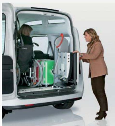
Plataformas monobrazo que permiten una excelente integración en el vehículo. Fabricadas en poliuretano, elimina todos los ruidos de la vibración del vehículo en marcha.
