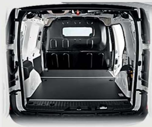
Suelos para todos los modelos de vehículos. Resistentes, lavables y antideslizantes. Con perfiles de aluminio y anclajes de sujeción de cargas
