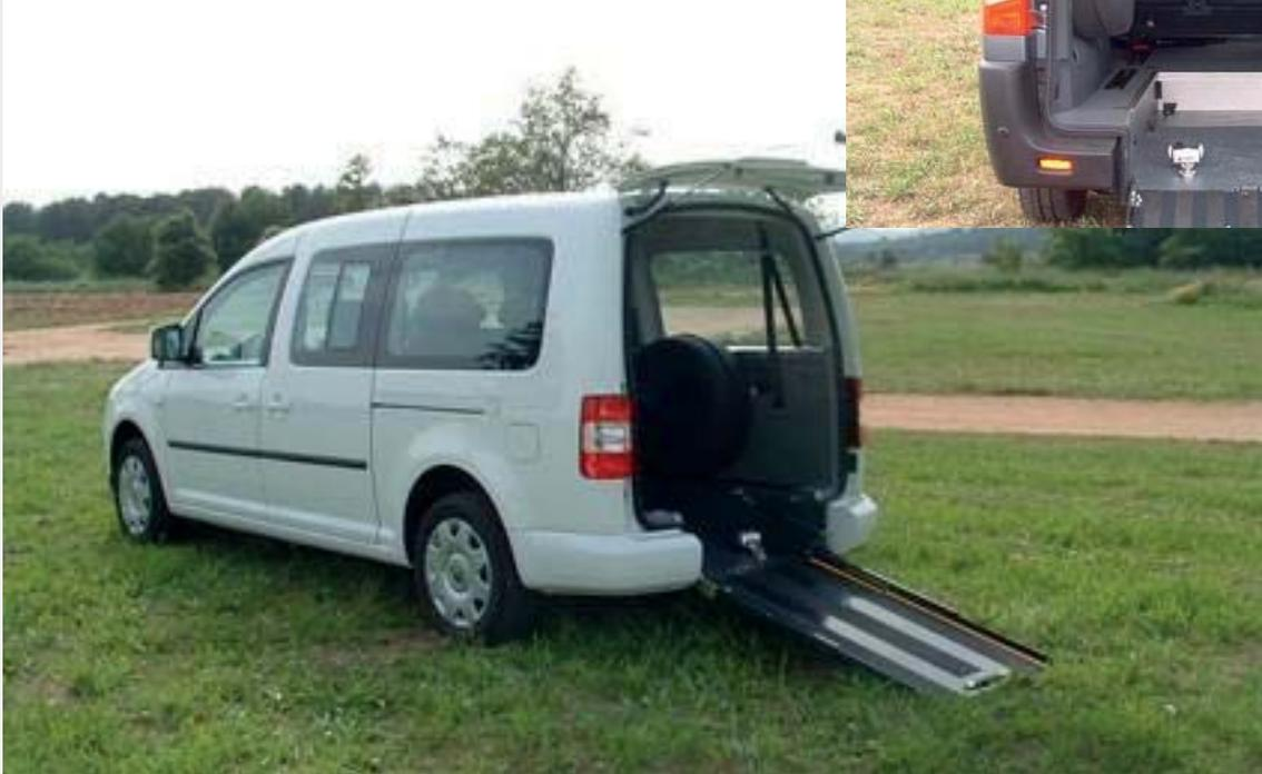
El vehículo rebajado facilita el acceso al vehículo del usuario en silla de ruedas. Este tipo de adaptación es fiable, segura y práctica. Permite solventar principalmente el problema de la altura interior del vehículo, creando un espacio óptimo para la comodidad del usuario.
