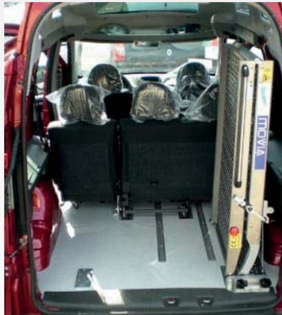
Las rampas manuales MOVIA tienen una nueva filosofía de entender el acceso directo al vehículo. Construidas íntegramente en aluminio. Sin soldaduras, con superficie anti-deslizante, ligeras y de fácil uso. Con versiones fijas, giratorias y automáticas. Diferentes medidas tanto de largo como de ancho para poder adaptarnos a cualquier necesidad para el transporte de Personas con Diversidad Funcional.
