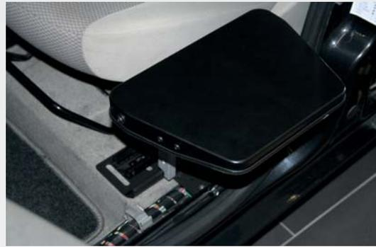
Dispositivo de transferencia diseñado para ser instalado en el vehículo para ayudar a las Personas con Diversidad Funcional.
