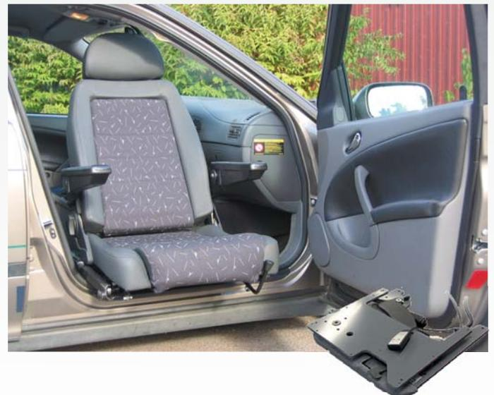
Base giratoria que permite girar el asiento desplazándolo y sacándolo hacia el exterior del vehículo para facilitar la transferencia. Simplifica el día a día del usuario con Diversidad Funcional. Posibilidad de que sea manual o eléctrica, para vehículos de dos o cuatro puertas y de derecha o izquierda.
