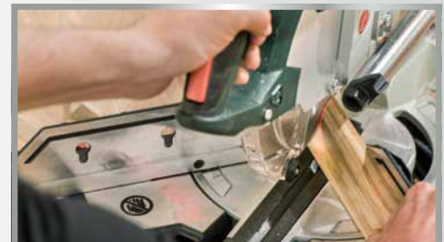
Láser de línea doble para indicar exactamente la línea de corte a la derecha e izquierda de la hoja de sierra
