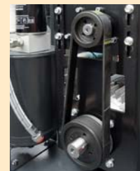
Transmisión La correa poly-V garantiza una larga duración (al menos dos veces superior a las correas trapecoides) y mínimo mantenimiento.
