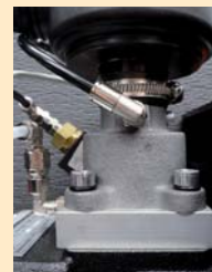
Regulador de aspiración Sistema electro-neumático normalmente abierto. Regula el funcionamiento del compresor garantizando la mínima presión necesaria durante la marcha en vacío, para lograr el máximo ahorro energético.
