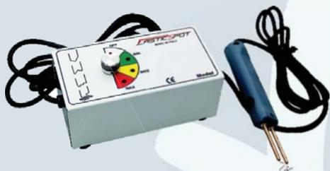
Soldadura para partes plásticas. Mediante la soldadura de grapas perfiladas
