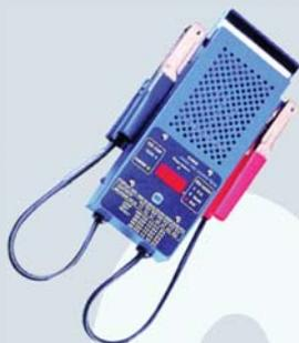
Indicador numérico del estado de la batería y analizador del sistema de carga. Prueba de 200 a 1000 CCA (6-12 V). Prueba del sistema de carga 12 V y del sistema de arranque del motor. Peso 1,2 Kg
