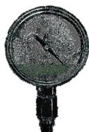
**Manómetro patrón de comprobación de extintores rosca macho con sistema de glicerina**
