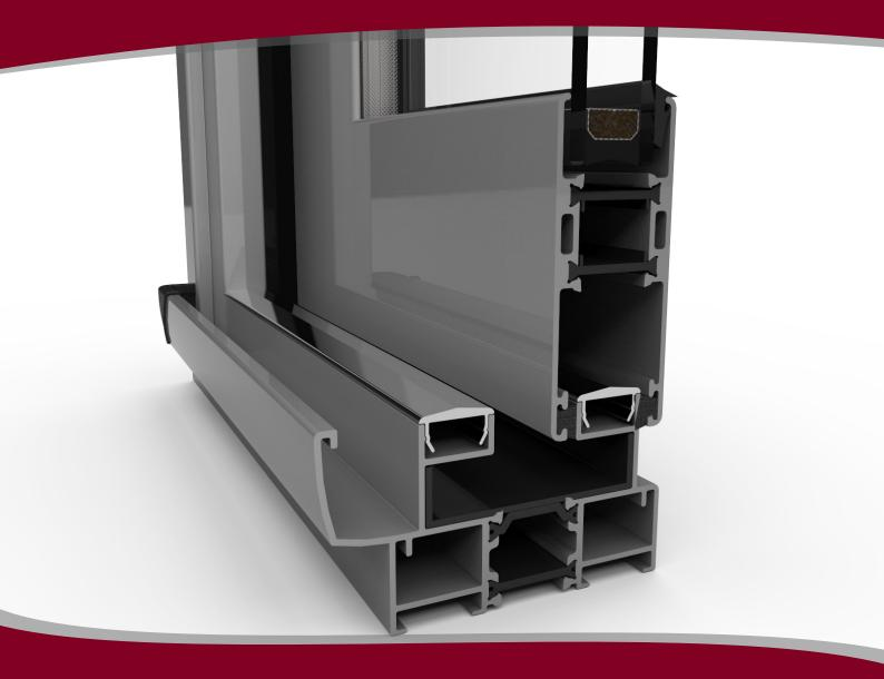
Carpintería corredera perimetral de 73mm, con rotura de puente térmico mediante pletinas de poliamida de 24mm tanto en el marco como en las hojas.
