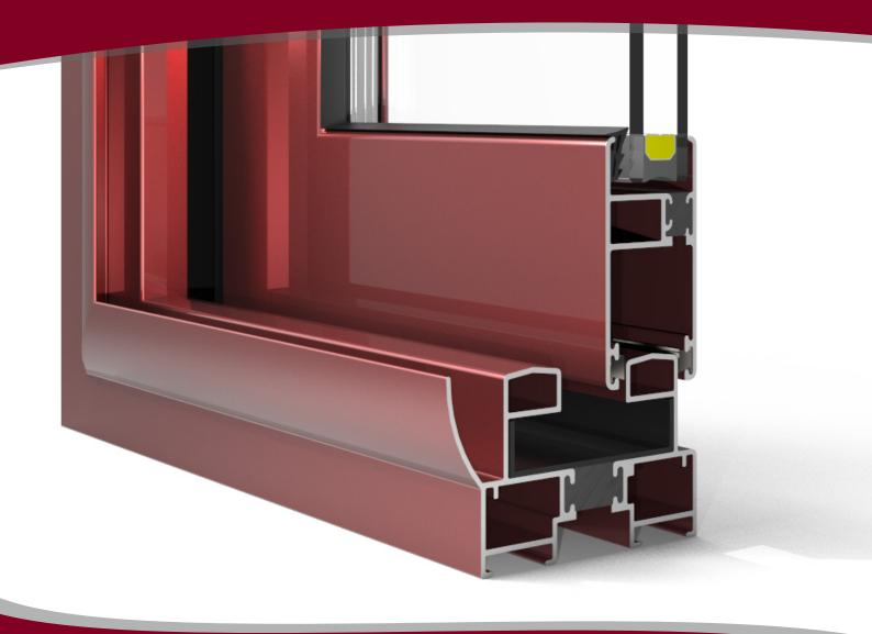
Carpintería corredera perimetral de 73mm, con rotura de puente térmico mediante resina de poliuretano de alta densidad.
