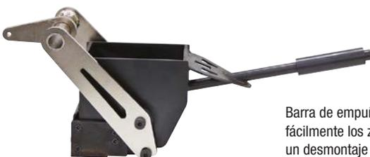
Barra de empuñadura para sustituir fácilmente los zapatones y realizar un desmontaje sin herramientas
