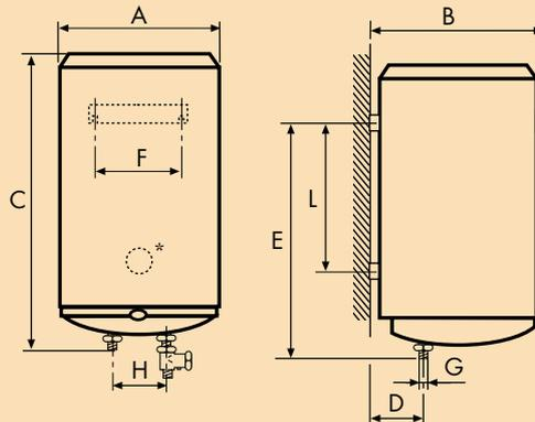
\* Los modelos de 100 y 150 L disponen de 2 soportes metálicos de fijación
