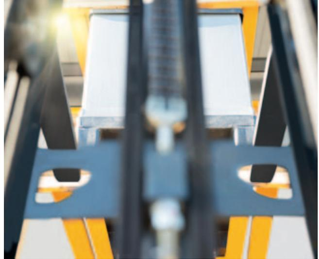
Perfecta visibilidad sobre las puntas de las horquillas a través de la ventana panorámica del travesaño del cilindro de elevación libre.
