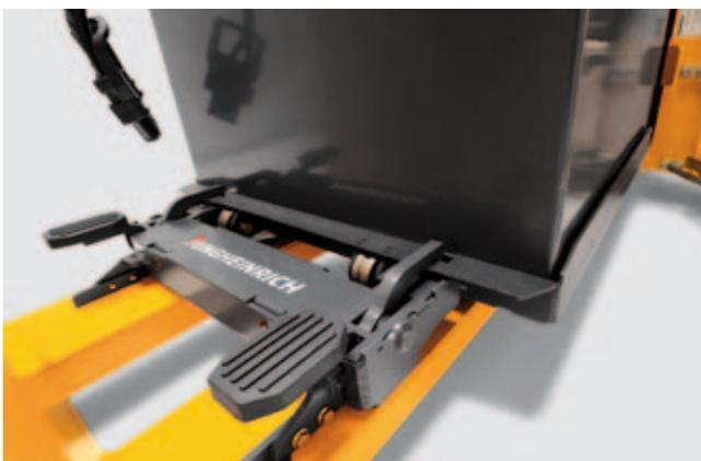
Dos pedales laterales para abrir o cerrar la conexión con el carro de batería.
