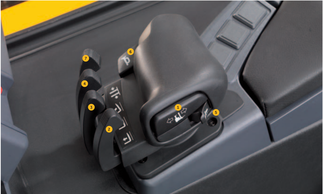
La palanca de mando SOLO-PILOT integrada en el reposabrazos.
