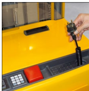
Cargador integrado para una carga cómoda de la batería en cualquier toma de corriente
