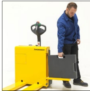
Cambio de batería por el lateral
