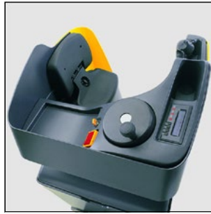
Máquina de conductor de pié ESE 120 con elementos de manipulación de fácil acceso y asiento abatible
