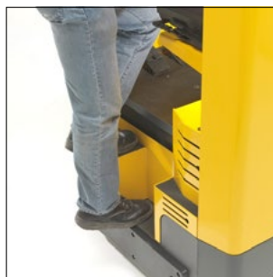
Acceso seguro mediante peldaño bajo y estribo
