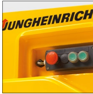
Dispositivo de marcha atrás para un acoplamiento/desacoplamiento cómodo
