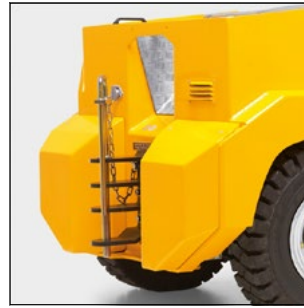
Enganche de bulón múltiple para diferentes alturas de barras en los remolques
