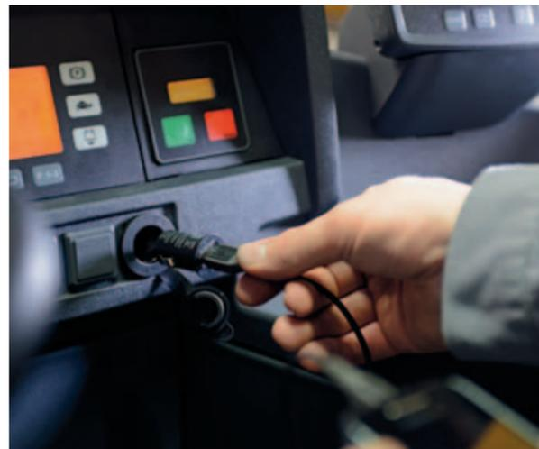
Toma de corriente de 12 V en el tablero de instrumentos
