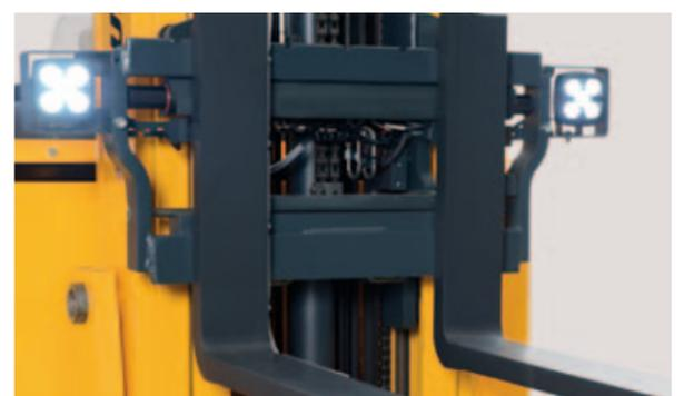
Las mejores condiciones de iluminación gracias a los focos dispuestos en el carro portahorquillas
