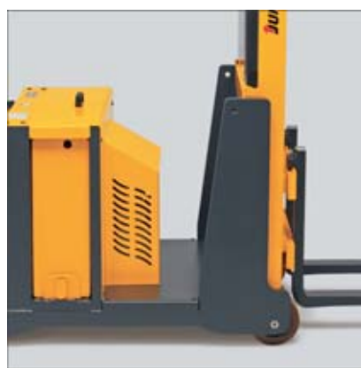
Extracción lateral de la batería (opción) y grupo hidráulico de ubicación adelantada
