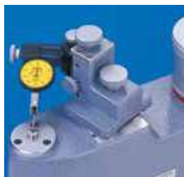
Comparador oscilante sometido a test.
