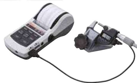
DP-1 VA con micrómetro de exteriores (opcional)
