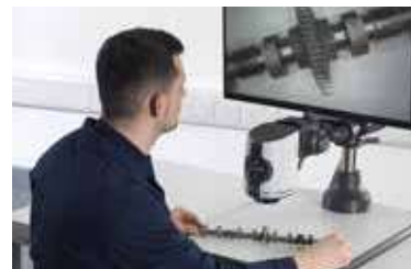
Control visual de una pieza mecanizada (EVO Cam con soporte doble brazo)
