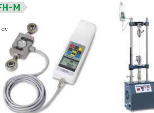
Dinamómetro de célula externa, montado en soporte D77657 (opcional)
