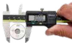
Control de boca de exteriores
