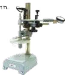
Comprobación de reloj montado sobre un alexómetro en posición horizontal
