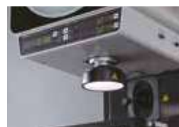
Ejemplo de instalación de iluminador circular LED en PJ-PLUS
