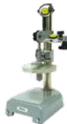
Verificación de comparadores de palpador oscilante.
