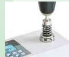
Test con resorte de torsión que debe emplearse para atornilladores eléctricos
