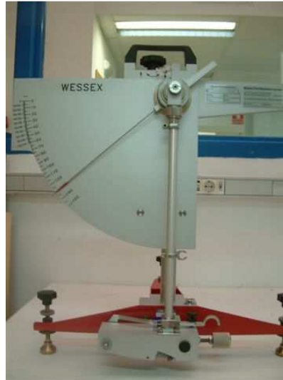
Detalle del equipo de “Resistencia al deslizamiento”
