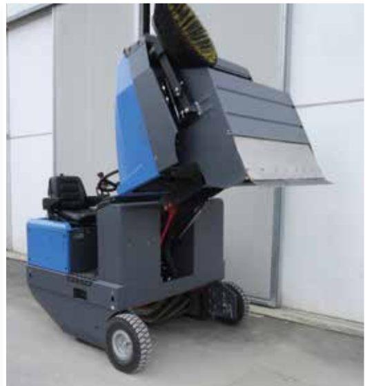
Sollevamento idraulico del contenitore rifiuti Hydraulic height dump up foe empty
