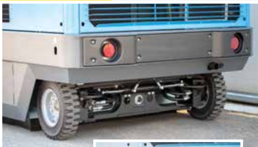
Versione a 4 ruote con le 2 posteriori motrici e sterzanti
