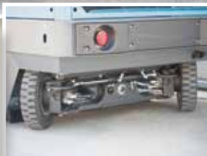
Versione a 4 ruote con le 2 posteriori motrici e sterzanti
