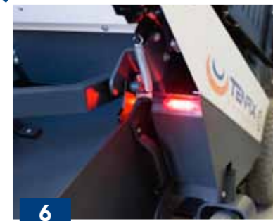
6 Luci al LED posteriori, disponibili sia sulla macchina che sul carrello. Rear LED lights, available both on the machine and the charriot
