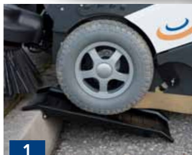
1 Rampe a bordo macchina per gradini alti e marciapiedi On board ramps for high steps and boardwalks
