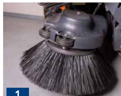
1 Spazzole anteriori protette da sistema di rientro antiurto. Front brushes protected by mechanical fuse.
