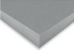
Compuesta por un alma de yeso enriquecida con fibra de vidrio. Placa utilizada en el sistema Shaftwall que protege del fuego hasta 180 minutos y ofrece una alta resistencia mecánica gracias a la placa Maciza 20. Además, facilita su instalación por un solo lado gracias al desarrollo de un Montante especial CT.
