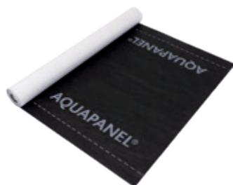
La barrera de agua AQUAPANEL® es una lámina resistente al agua y al viento con permeabilidad al vapor de agua. Es usada como una membrana de protección al agua fijada al perfil metálico, previa colocación de la placa AQUAPANEL® Outdoor, evitando que el agua penetre dentro del tabique de fachada.
