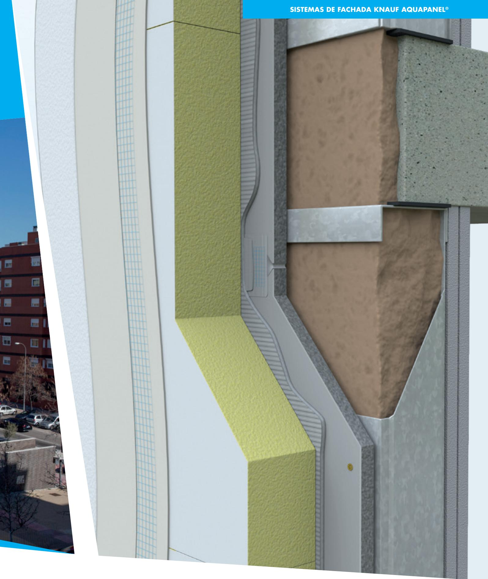
de AQUAPANEL®, sobre la que se fija un sistema SATE, acabado con un mortero blanco y pintura lisa. Por el interior de la estructura principal se ejecutó un trasdosado autoportante inclinado con doble placa de yeso.
