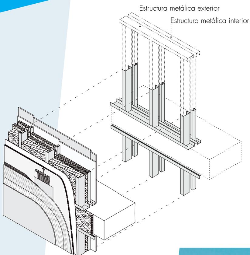
Los sistemas de fachada Knauf AQUAPANEL® se sustentan sobre un entramado autoportante a base de perfiles de acero galvanizado. Estos elementos disponen del correspondiente marcado CE conforme a la norma UNE-EN 14195.
