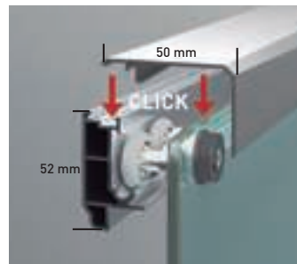
Cerco cerrado oculta rodamiento. Mediante tapa decorativa clipada.
