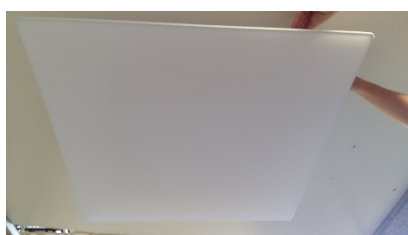
Fig. 8 colocar la tela en dos esquinas, estirar hacia la tercera y cuarta, ajustar la tela a la estructura hasta que no queden arrugas.
