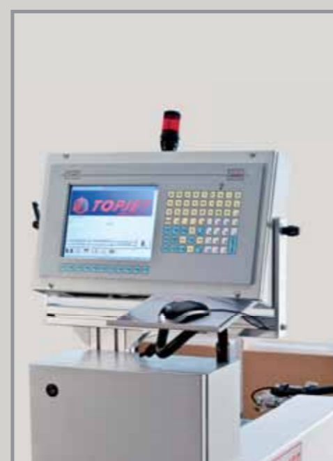
PANEL DE CONTROL CON ORDENADOR Y TECLADO DE MEMBRANA
