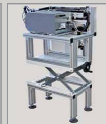
SOPORTE DE PANTÓGRAFO PARA LA REGULACIÓN DE LA ALTURA MEDIANTE VOLANTE
