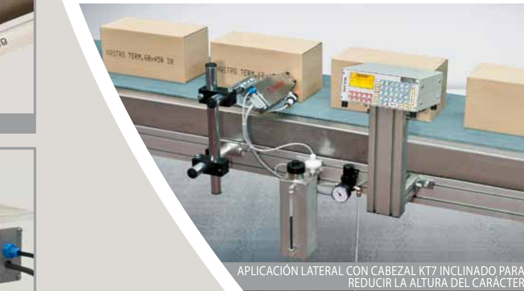
APLICACIÓN LATERAL Y VERTICAL CON DOS CABEZALES KT7
