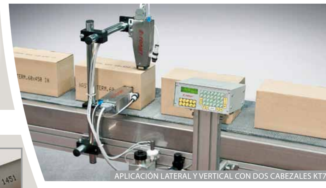
APLICACIÓN LATERAL CON CABEZAL KT16
