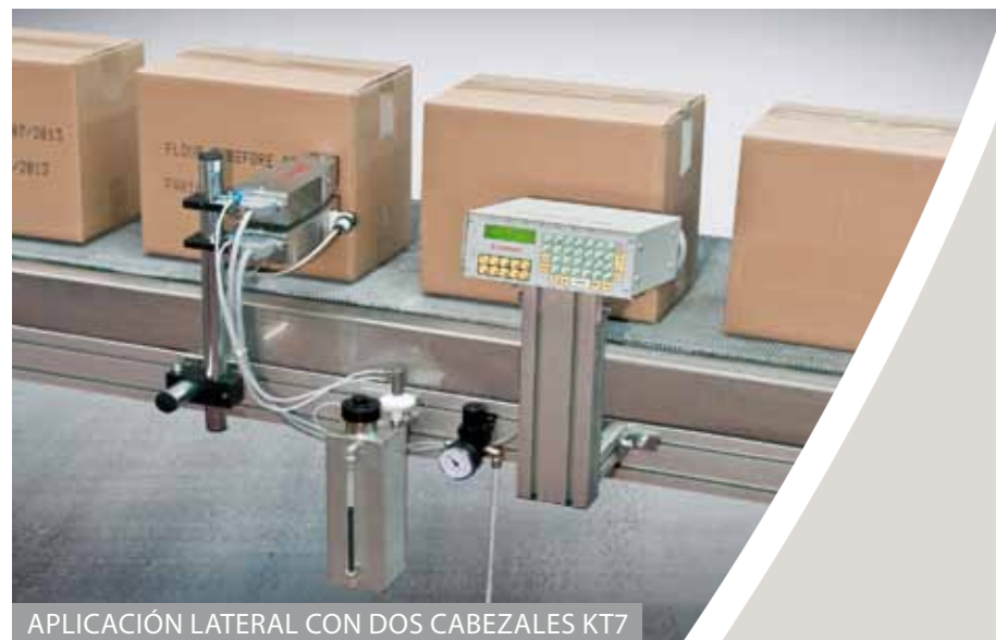
APLICACIÓN LATERAL CON DOS CABEZALES KT7
