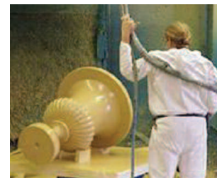
Proyección del Styrothane
