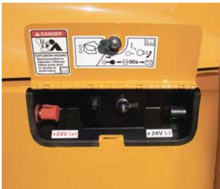
*Interruptor de apertura del capó y de encendido/apagado de la batería*
