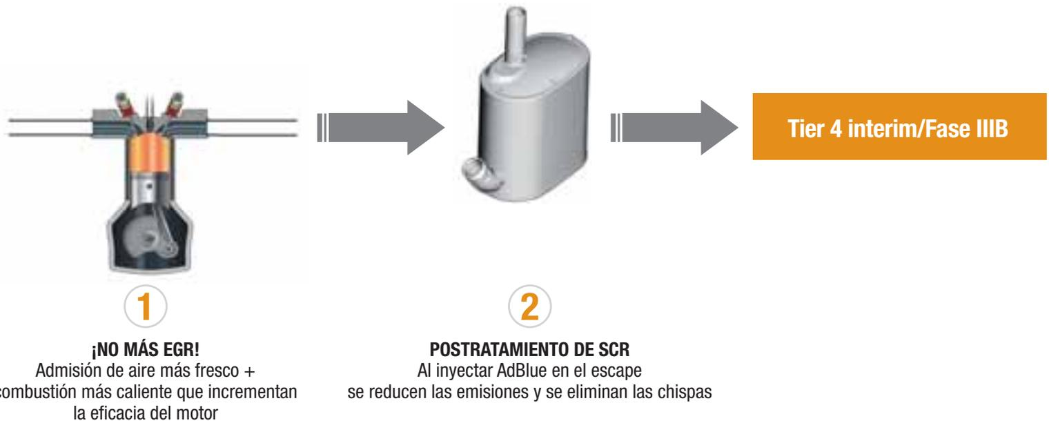
La solución «Sólo SCR» de Case es un sistema de tratamiento posterior que reduce el nivel de emisiones sin limitar el rendimiento del motor. La combustión a altas temperaturas con aire fresco desarrolla más densidad de potencia con menos combustible, lo que tiene como resultado unas potentes prestaciones y una excelente eficiencia en consumo de combustible.
