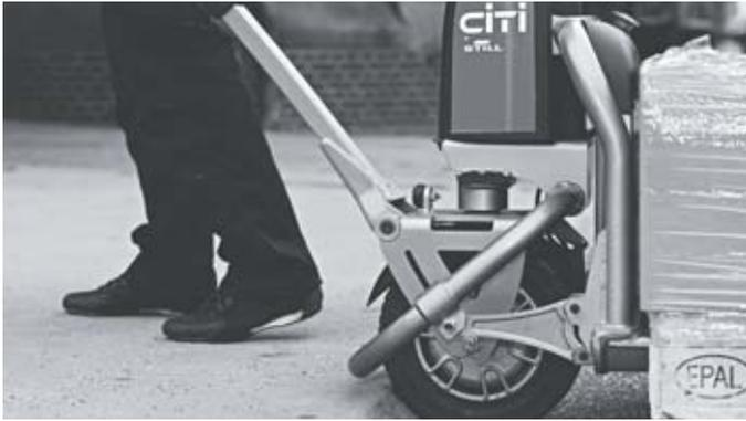
Se puede utilizar sobre cualquier suelo gracias a la rueda de tracción perfilada totalmente de caucho
