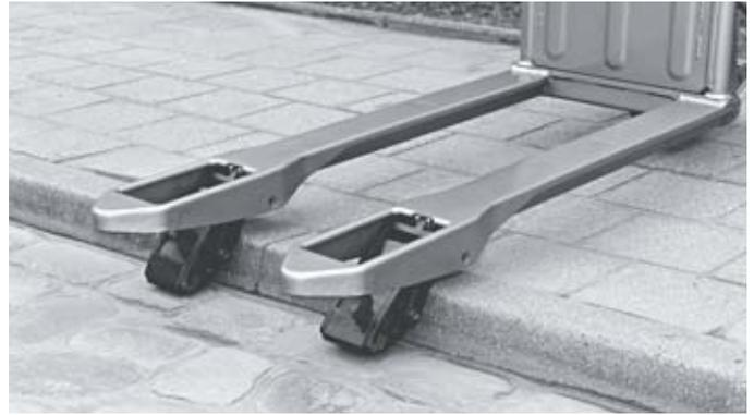
Fácil paso de bordillos y escalones de hasta 70 mm gracias a los patines de escalado
