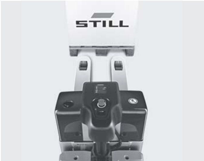
Prestaciones óptimas y visibilidad de las puntas de las horquillas gracias a la carrocería baja
