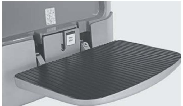
La plataforma del conductor amortiguada neumáticamente permite trabajar sin fatiga y aumenta el rendimiento del operario
