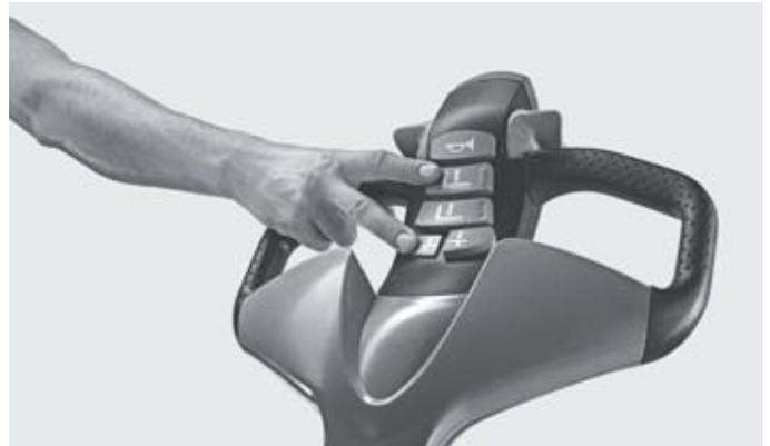
Manejo preciso del EXD 18 y del EXD 20 gracias a la diferenciación táctil entre los botones de elevación y descenso
