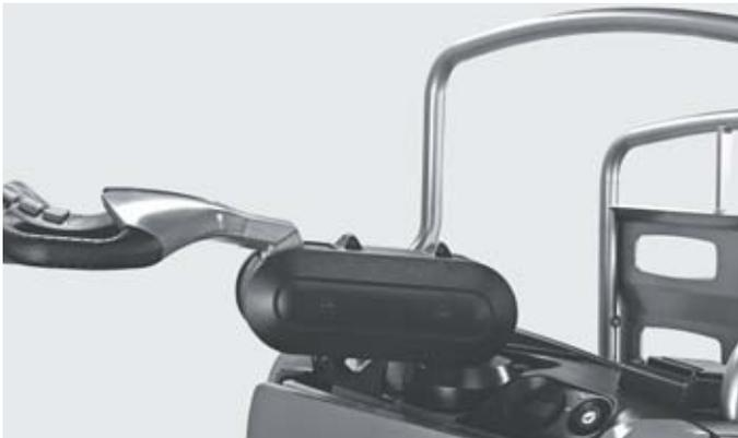
Circulación segura también en el modo de conductor acompañante gracias al exclusivo timón combinado de STILL que mantiene una distancia de seguridad óptima con respecto al apilador
