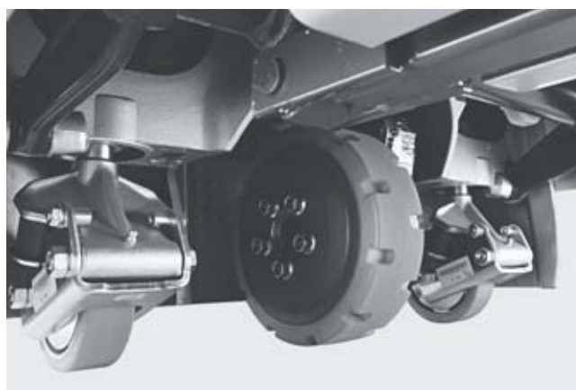
Rueda de tracción perfilada
