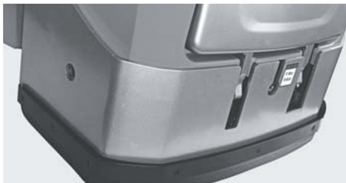
Máxima protección del conductor: placa de impacto sensitiva en la posición óptima más protección de pies ajustable en altura
