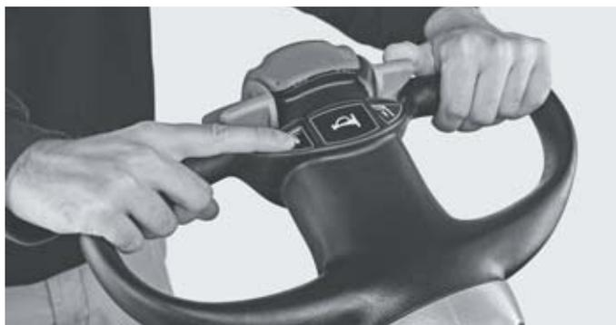
Operación intuitiva y ergonómica: los procesos de conducción, elevación y dirección pueden controlarse por operadores zurdos o diestros con una sola mano
