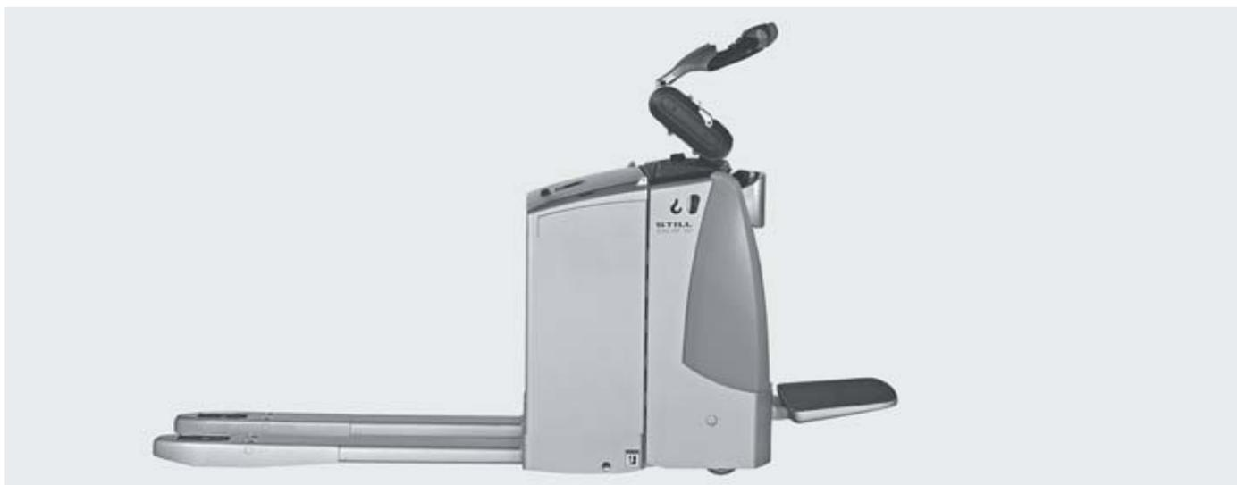
Conducción cómoda: en el modo de conducción sobre la plataforma óptimamente acolchada, la carretilla puede alcanzar hasta 6 km/h cuando las protecciones laterales están plegadas.
