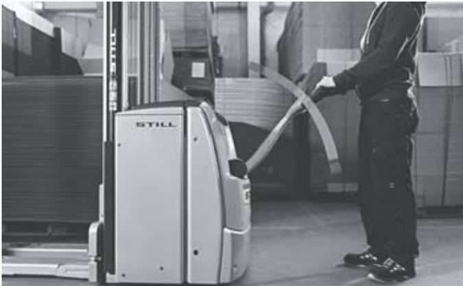
La seguridad de serie: dependiendo del ángulo del timón, la velocidad se adapta automáticamente a la distancia entre el operador y la máquina
