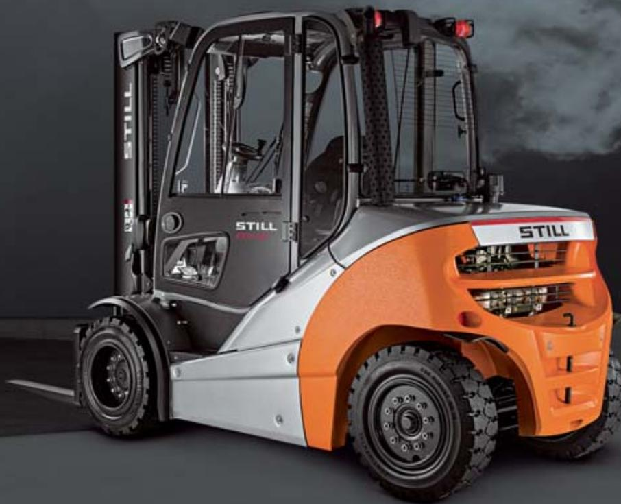
Y el freno eléctrico libre de desgaste tipo “pie fuera del acelerador” literalmente deja “pegada” la carretilla al pie del conductor, por lo que es imposible descontrolarse en superficies irregulares o rampas. Gracias a un motor Diésel de 2,9 l Deutz con un moderno catalizador de oxidación, el nivel de emisiones de este portento de compactas dimensiones es tan reducido que queda muy por debajo de los valores límite legales para gases de escape determinados por la normativa 97/68/CE nivel 3b.
