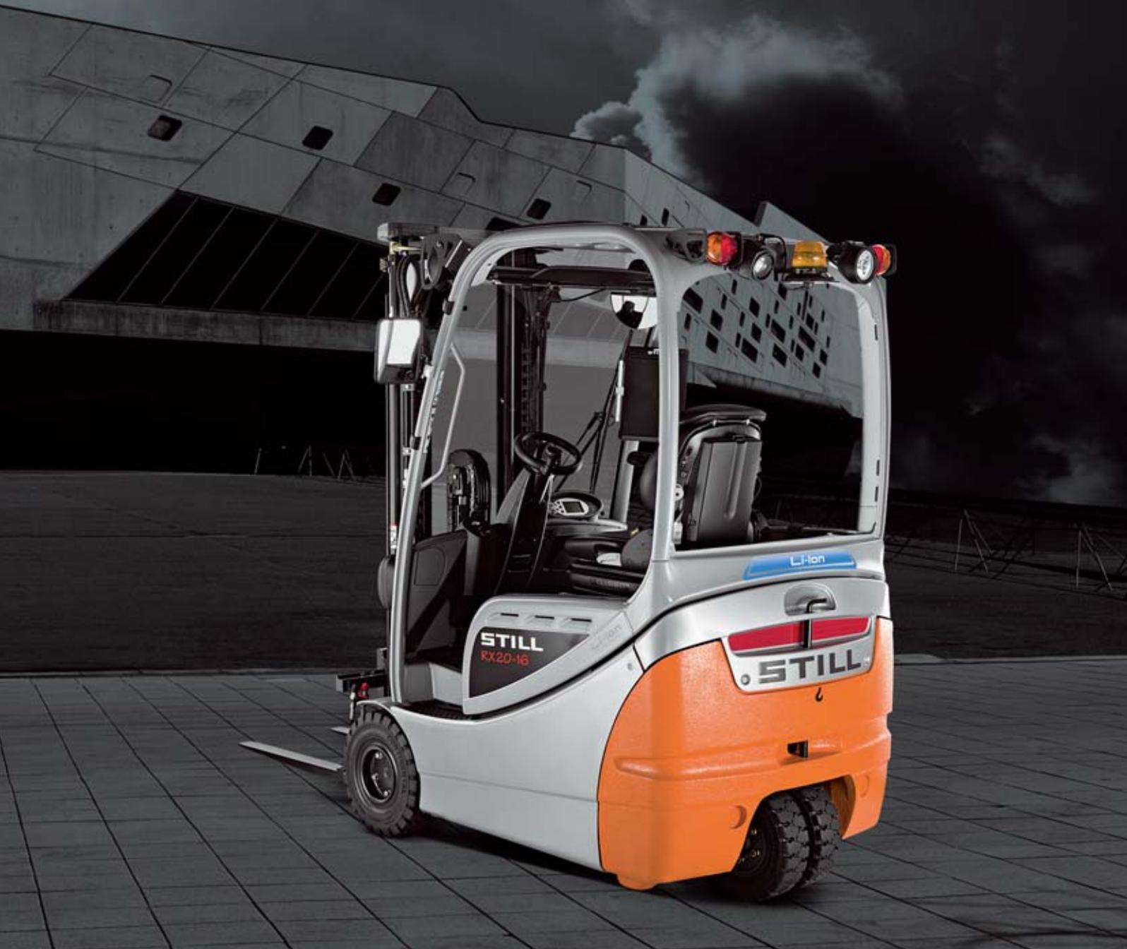
La **RX 20 Li-Ion** ofrece un cúmulo de energía eficiente y compacto y garantiza una disponibilidad óptima. No es solo posible una carga intermedia al 50% en tan solo 30 minutos, sino que la carga total es una hora más rápida que con la de la anterior batería de Plomo.
