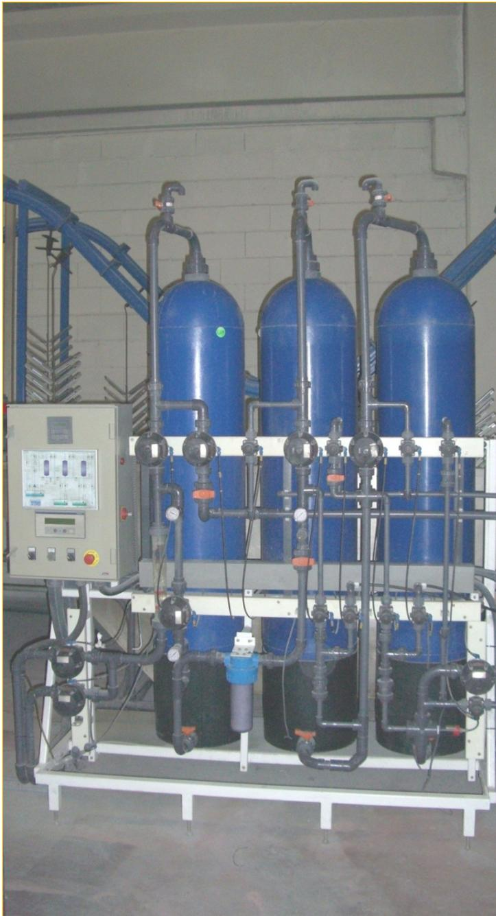
← SISTEMA DE DESMIRALIZACIÓN DEL AGUA
