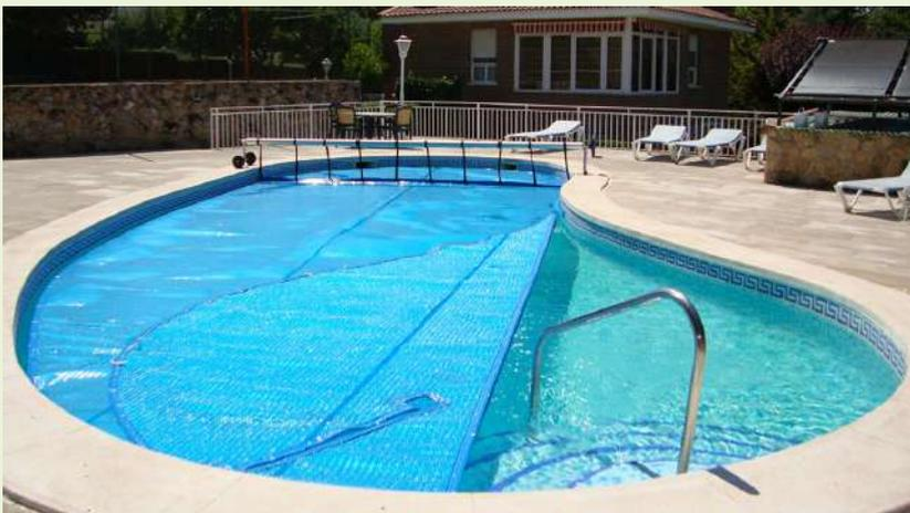
Los cobertores isotérmicos constituyen un gran apoyo a cualquier sistema de calefacción y un gran ahorro en el coste energético, su eficacia se basa en evitar el contacto directo del agua con el aire, reduciendo muchísimo la pérdida de calor y evitando también la evaporación, ahorrando agua y productos químicos.
