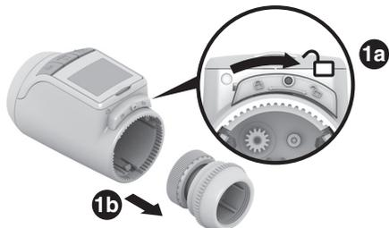
1. Separar del termostato de radiador el módulo de acoplamiento de la válvula. Deslizar para ello la corredera en dirección
